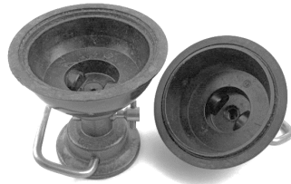
Abbildung 4: Zwei Halbkugelschalen aus einer physikalischen Sammlung, welche für die Nachstellung des Halbkugelversuchs genutzt werden
