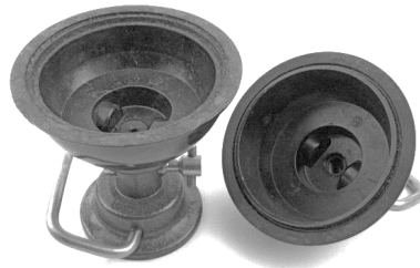
Abbildung 3: Zwei Halbkugelschalen aus einer physikalischen Sammlung, welche für die Nachstellung des Halbkugelversuchs genutzt werden
