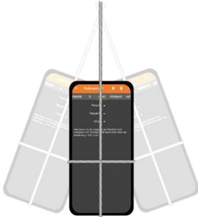
Die **Aufhängung** eines mobilen Gerätes, z.B. Smartphone durch **Einknoten in einen Bindfaden** hat neben dem Aspekt eines fehlenden Schutzes für das Gerät auch den Nachteil, dass das pendelnde Gerät oft eine Torsionsbewegung ausführt. Durch Verdrehen oder auch seitliches Verrutschen kommt es zu gravierenden Abweichungen und Messfehlern.
