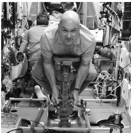
Abb. 1: Das Body Mass Measurement Device (BMMD) mit Astronaut
