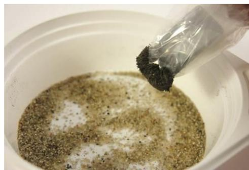
Arbeiten mit dem verpackten Magneten als „Eisensauger“.
