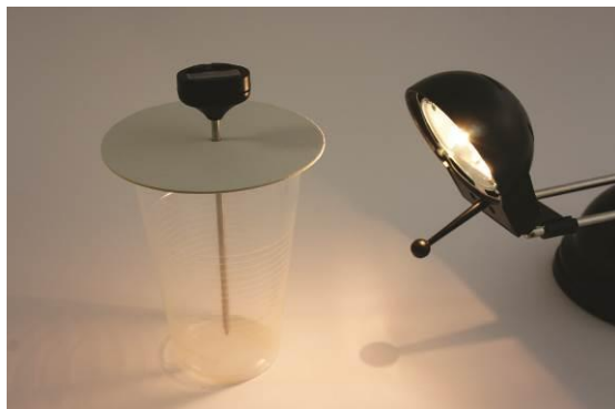
Messen der Temperatur im geschlossenen Becher, der mit Kohlendioxid gefüllt ist.
