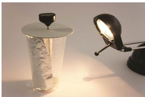
Messen der Temperatur im geschlossenen Becher mit weißem Papier oder Alufolie.
