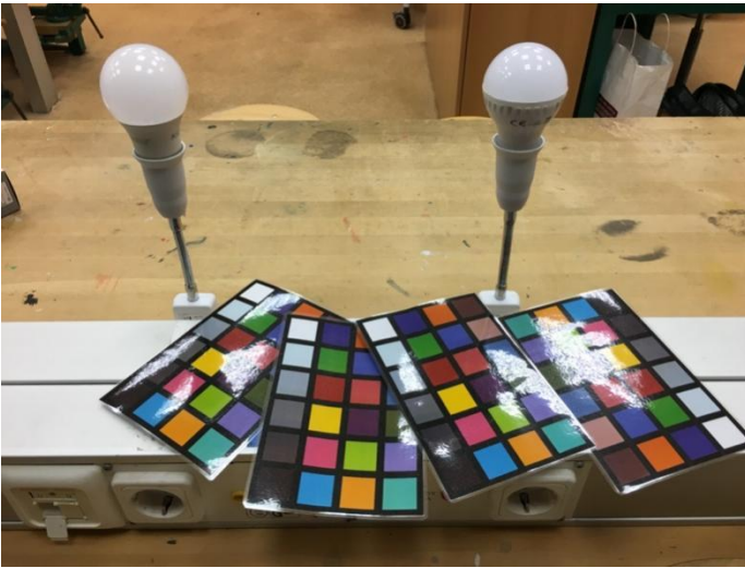
Abbildung 5: Möglichkeit, Leuchtmittel mit Hilfe von Fassungen direkt an einer Werkinself anzubringen.
